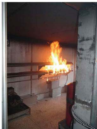
Огневой модуль «горящий кабель канал»
