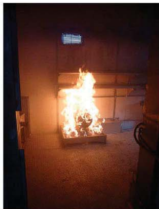
Огневой модуль «горящий электродвигатель»
