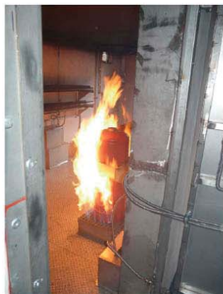
Огневой модуль «горящие газовые баллоны»
